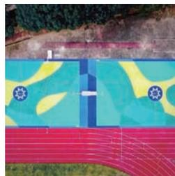
旧鞋通过Grind技术的拆解和再次加工，制成橡胶颗粒用于铺设球场，两个耐克“同心鞋力”篮球场于武汉市碧云小学正式落成。
